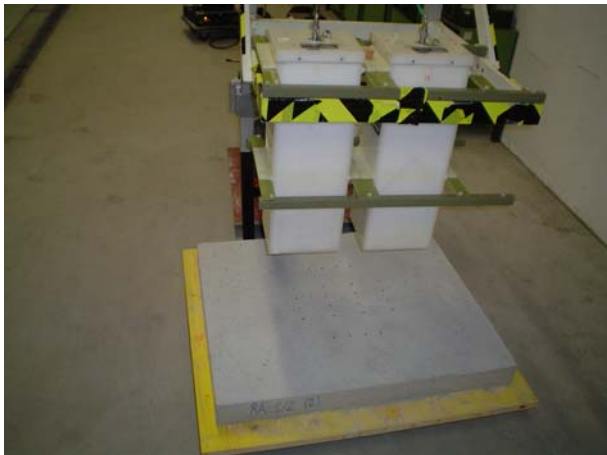
Figure 8-10: Mesures avec antennes cornets au-dessus de l'échantillon
