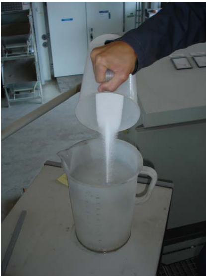
Figure 8-1: Adjonction du chlorure dans l'eau de gâchage
