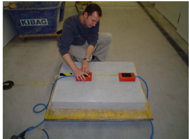
Figure 8-20: Mesures avec écart variable entre émetteur et récepteur
