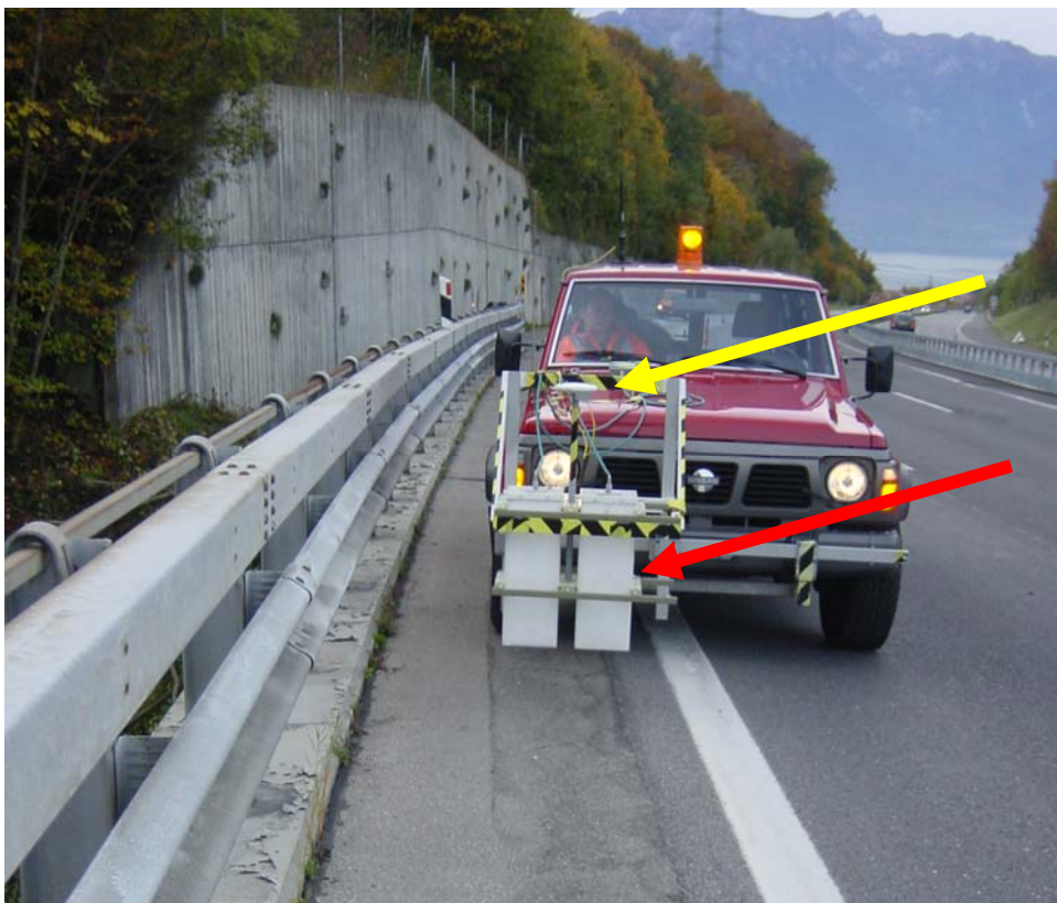
Figure 9-4: Avant du véhicule de mesures avec les antennes radar (flèche rouge) et l'antenne GPS (flèche jaune)
