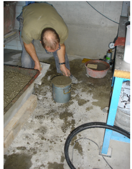
Figure 8-3: Contrôle du béton frais
