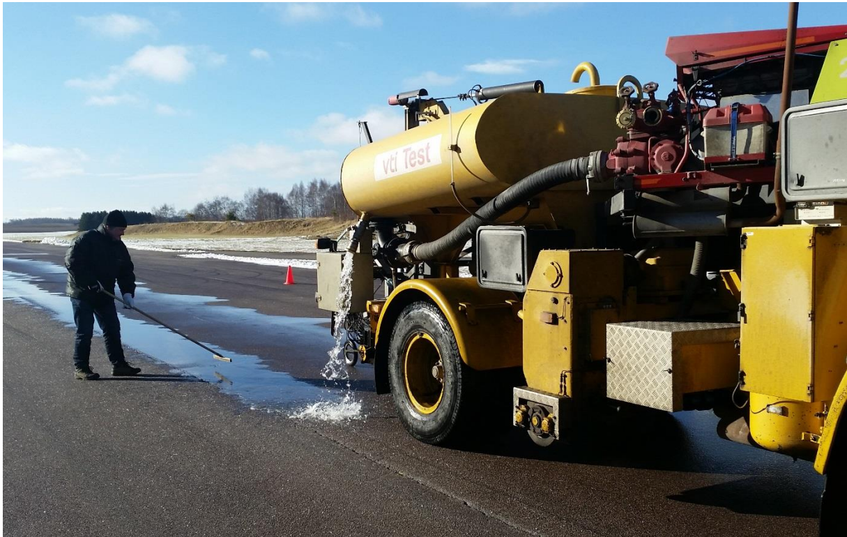
Figur 8. Vattning av testbanan. (Foto Carl Södergren, VTI)
