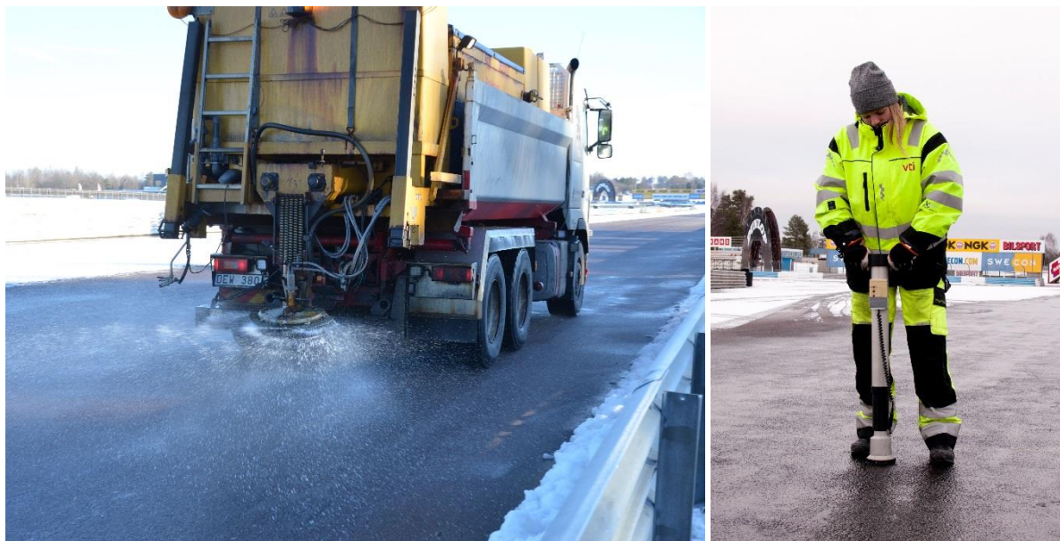
Figur 7. Saltning av testbanan. (Foto Carl Södergren, VTI). Mätning av salthalt. (Foto Mattias Hjort, VTI)
