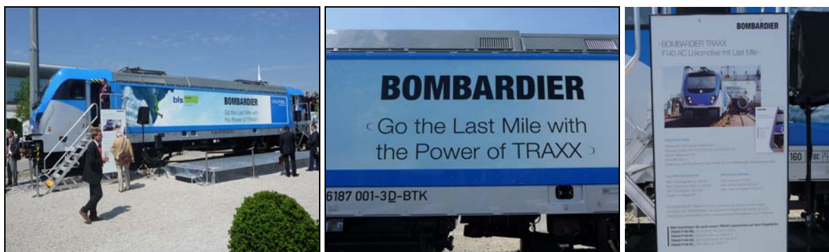
Abb. 5.3-4: Elektrische Streckenlokomotive der TRAXX-Familie von Bombardier mit Diesel-Hilfsantrieb
