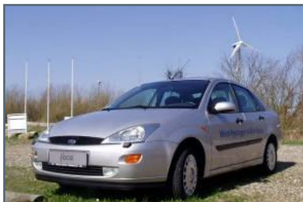
Ford Focus med motor ombygget til brintdrift (Nordisk Folkecenter for Vedvarende Energi)
