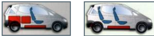
DaimlerChyslers to prototyper med metanol-lagring – NECAR 3 fra 1997 og NECAR 5 fra 2001. (ill: DaimlerChrysler)
