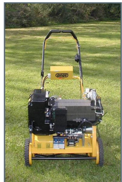
Brændselscelle-drevet plæneklipper udviklet af Teknologisk Institut
