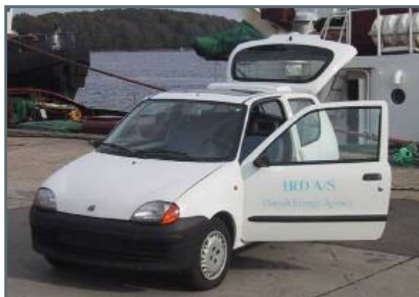
Fiat Seicento Elettra, ombygget til brintdrift (IRD Fuel Cell A/S)
