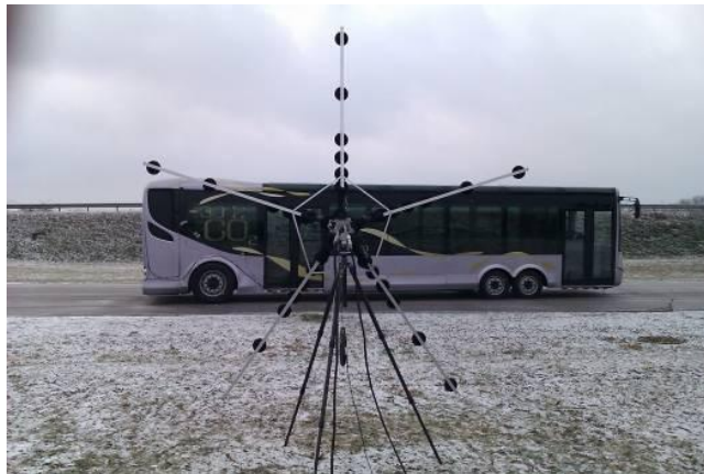
Figure 6 : mesure du Citelis au bruit de passage pour imagerie acoustique
