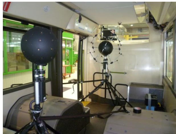
Figure 2: antennes de mesure développées par le LVA à gauche et MicrodB à droite
