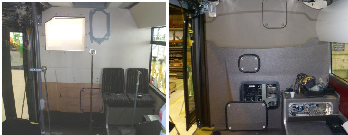
Figure 22 : mise en œuvre de solution de réduction de bruit par isolation entre le Citelis P2 à gauche et le Citelis à venir C9
