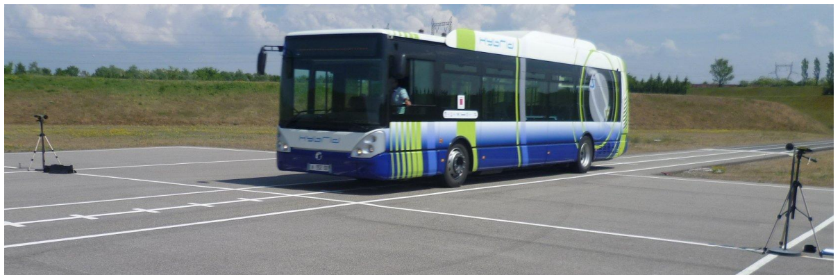
Figure 8 : mesure au bruit de passage du Citelis hybride.
