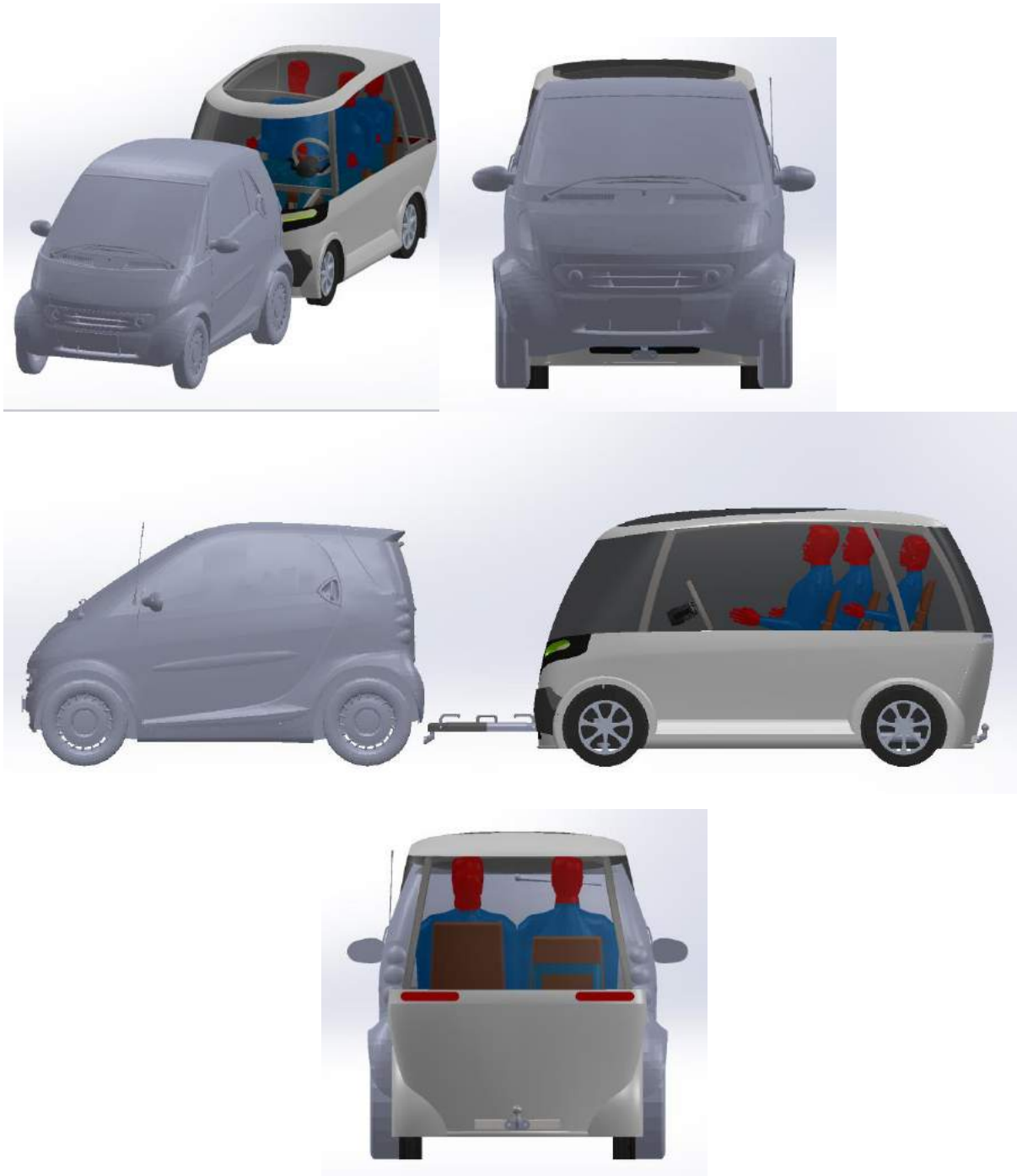
Abbildung 81, Sparvariante 2 – Koppeln des SynArea-Fahrzeuges an einen konventionellen Pkw
