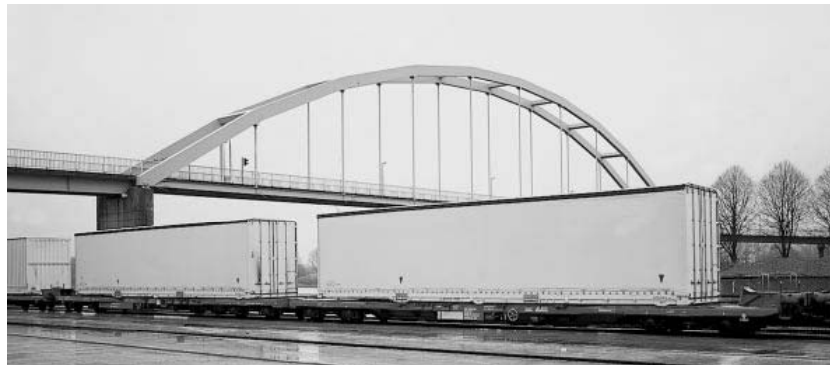
Abbildung 10: 8-achsiges kurzgekuppeltes Tragwagen Sffggmrrss zum Transport von Highcube-Behältern (9'6'') [www.aae.ch]
