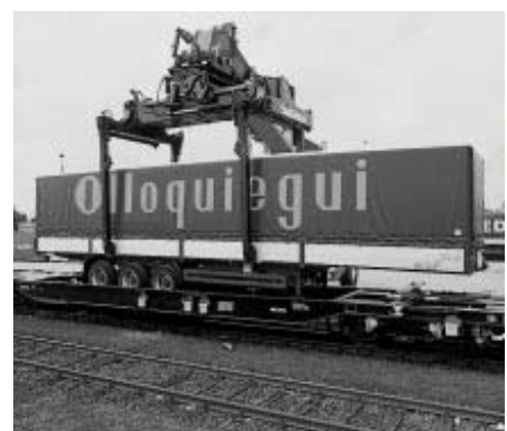
Abbildung 9: 6-achsiger Doppeltaschenwagen Sdggmrss 104' zum Transport von Sattelanhängern (Megatrailer), Wechselbehältern und Containern[www.aae.ch]
