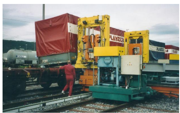
Abbildung 27: RTS 501: Umschlag von Container (links) und Wechselbehälter (rechts)
