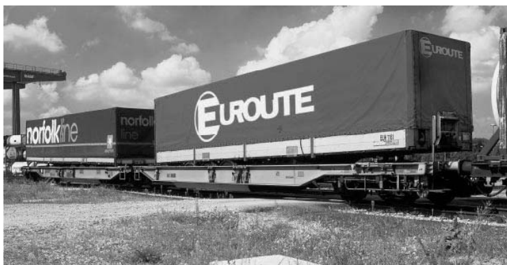
Abbildung 9: 6-achsiger Doppeltaschenwagen Sdggmrss 104' zum Transport von Sattelanhängern (Megatrailer), Wechselbehältern und Containern[www.aae.ch]
