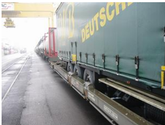
Kombinierter Tiefladewagen für Sattelanhänger, Container und Wechselbehälter
