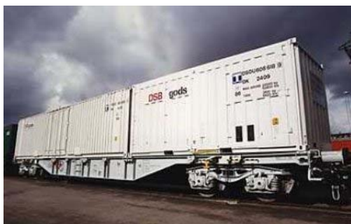
Abbildung 7: 4-achsiger Tragwagen Sgss 60' [www.aae.ch]
