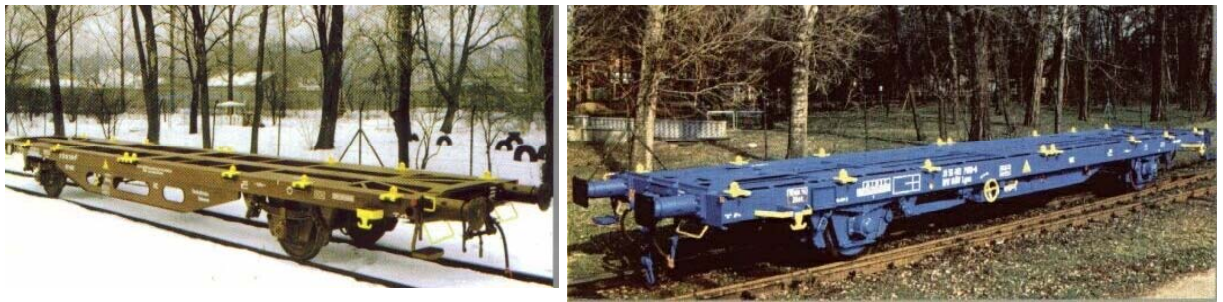
Abbildung 6: 2-achsige Tragwagen Lgs (links) und Lgss (rechts) [www.dbjarmu.hu]
