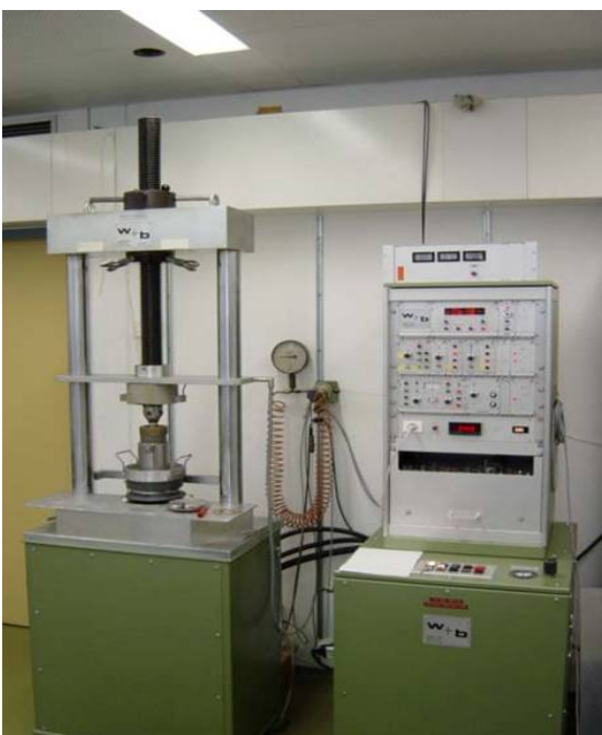
Bild 8. Versuchsapparatur zur Messung des CBR-Wertes
