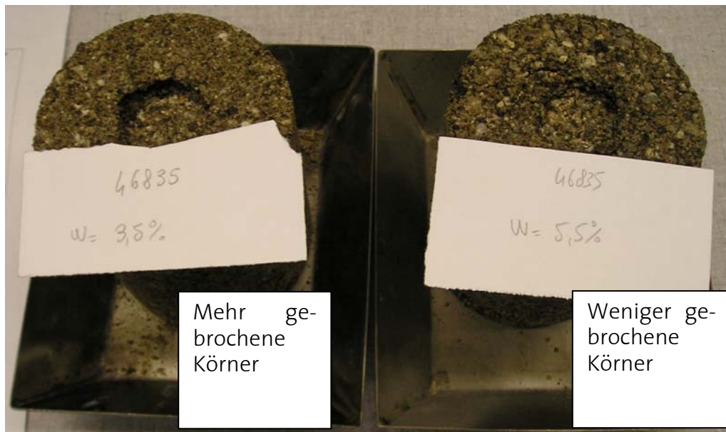
Bild 20. Der Unterschied in der Änderung der Kornverteilung, durch die zwei verschiedenen Verdichtungsverfahren erzeugt, ist auch optisch auffällig
