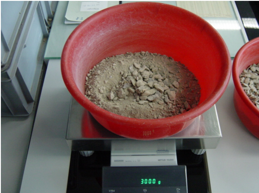
Bild 3. Material Mischung und Vorbereitung der Probe nach der originalen Kornverteilung (AASHTO Topf)
