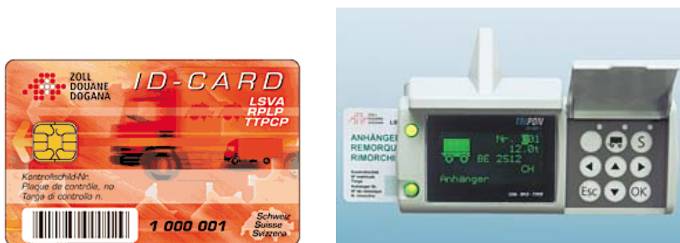
Grafik 4-4: ID Card für ausländische Schwerverkehrsfahrzeuge mit ID-Nummer sowie LSVA On bord unit (ID-Nummer gespeichert)
